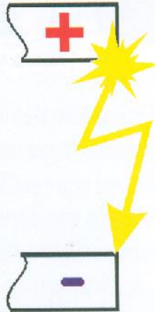
Überschlag an den Kanten
