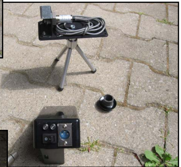
Abb. 7.02 / Infrarot-Reflektionslichtschanke (Gehäuserückseite und Befestigungswinkel für Infrarotsensor)
