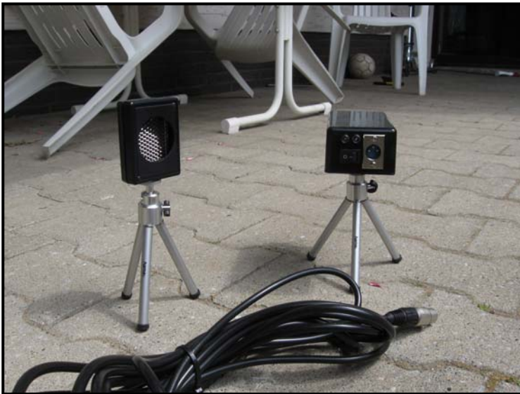
Abb. 7.01 / Infrarot-Reflektionslichtschanke und Reflektor
